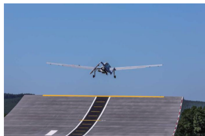
图10 “旗手”TB3无人机圆满完成首轮滑跃起飞试验
