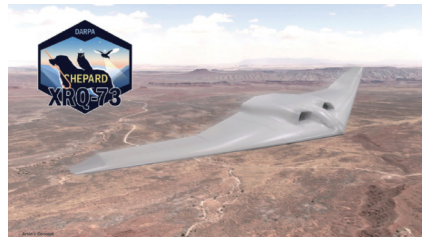
图22 XRQ-73混合电推演示验证机
